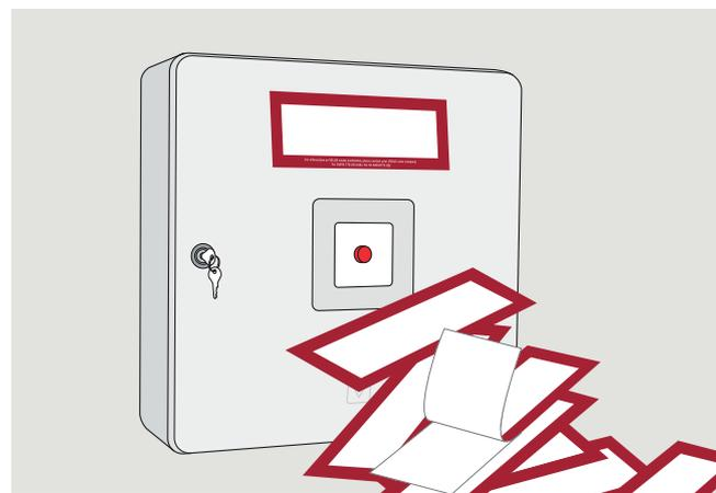
Attacca l'etichetta "EVACUATORE FUMO" fornita sull'area indicata dell'unità di controllo.
