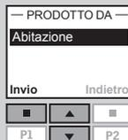
4 Il display visualizza una lista di tutti i prodotti dell'Abitazione. La tipologia di prodotto, in questo caso la Finestra, appare nella seconda riga del display. I singoli prodotti possono essere selezionati premendo per un breve lasso di tempo. Questa operazione azionerà il prodotto per alcuni secondi.
