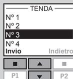
Qualora una finestra venga aperta con il telecomando, è possibile impostarne la chiusura automatica dopo un certo lasso di tempo. Per esempio è possibile arieggiare brevemente la propria abitazione quando si torna a casa dal lavoro. La programmazione di chiusura automatica deve iniziare entro 5 secondi dall'azionamento della finestra tramite telecomando. Le possibili opzioni sono: Disattivato, 5 min, 10 min, 15 min, 20 min, 30 min, 45 min e 60 min.
