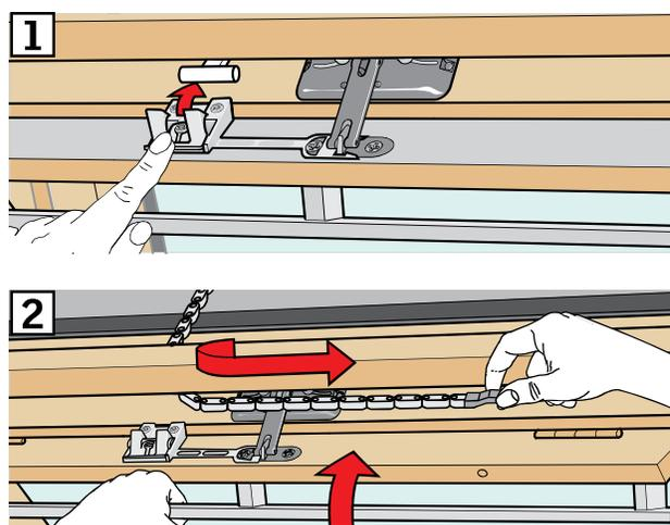
Una volta ripristinata la tensione di rete o ricaricata la batteria, la catena deve essere riagganciata.
