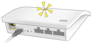
Connetti l'interfaccia all'alimentazione di rete. Quando il diodo luminoso giallo lampeggia, l'interfaccia è pronta per la configurazione.
