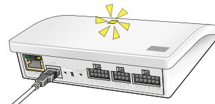
Quando il diodo luminoso lampeggia giallo, l'interfaccia è stata resettata. Ciò può richiedere fino ad 1 min.
